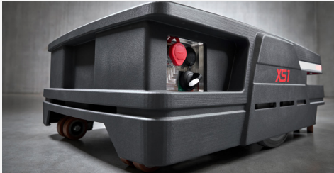
Anschlüsse und Hauptschalter
