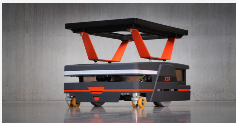
Projektaufbau für Box-Transport (max. 600 × 400 mm)
