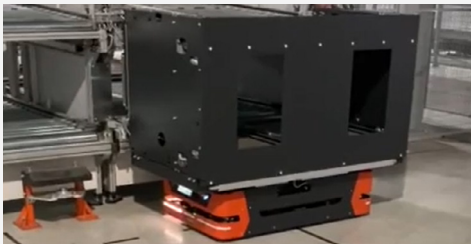
Fördertechnik-Aufbau als Anwendungsfall
